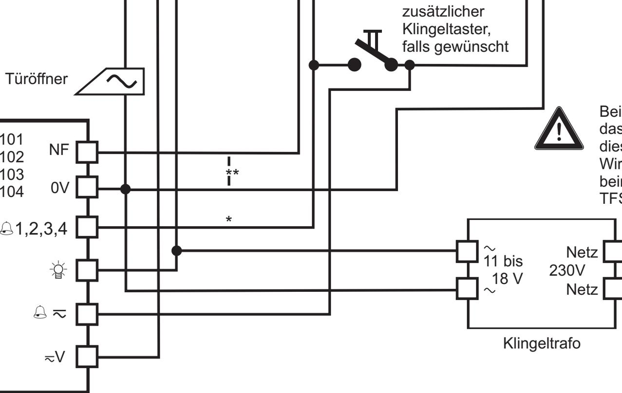
Bei der Verwendung eines Klingeltrafos für das TFS-Dialog 100 und den Türöffner muss dieser ausreichend dimensioniert werden. Wird der Trafo unterdimensioniert, kann es beim Öffnen der Tür zu Störgeräuschen im TFS-Dialog 100 kommen.
