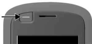
Die Funktions-Taste kann mit einer Funktion Ihrer Wahl belegt werden (**Abheben-Taste / Kurzwahl / Taschenlampe / Alarm-Taste / Systemfunktion**).
