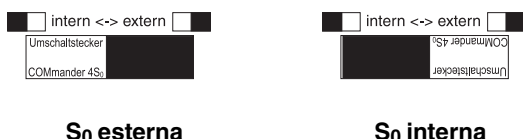
Fig. 6: Posizione ponticelli sul modulo COMmander 4S 0 (rev. 2)
