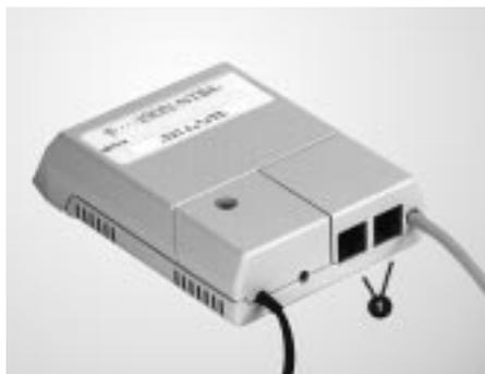
Für den Anschluss Ihrer ISDN-Geräte wird in Ihrer Wohnung / Ihrem Büro ein NTBA (Netzabschlussgerät für den Basisanschluss) installiert. Sie erkennen den NTBA an seinem grauen, rechteckigen Gehäuse und den zwei Buchsen ① (den sogenannten IAE-Steckdosen), die sich meist an der unteren Stirnseite des Gehäuses befinden.
